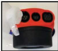
1. Verwenden Sie Isopropylalkohol, um die Innenseite aller Steckerbuchsen zu reinigen.
