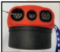
2. Führen Sie die Metallbürste (im Audio-Wartungssatz enthalten) mehrmals in jede Fassung ein, um den Schmutz zu lösen und zu reinigen. Wenn Sie nicht im Besitz des Audio-Pflegekits mit Metallbürste sind, können Sie diesen Schritt durch einen Rohrreiniger ersetzen.
